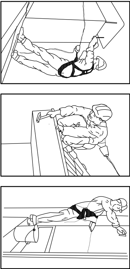
ANCLAJES CINTURON DE SEGURIDAD (Seguro de anclaje móvil)
